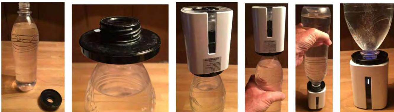
Also erst den Gewinde-Adapter auf die gefüllte Flasche schrauben, dann den Generator auf den Adapter schrauben, dann die Flasche anfassen und auf den Kopf wenden und mit dem Generator nach unten auf eine ebene Fläche stellen und die Starttaste des Generators drücken.
