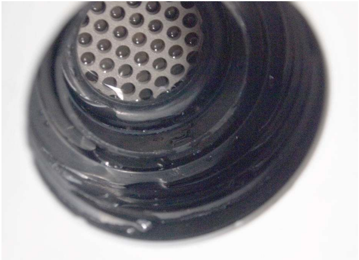
Erster Versuch: O-Ring in Winkel PEM/Gehäuse klemmen
