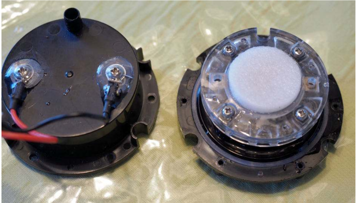
PEM-Kapsel geöffnet, rechts: Vlies-Pad zur Befeuchtung auf der PEM-Einheit
