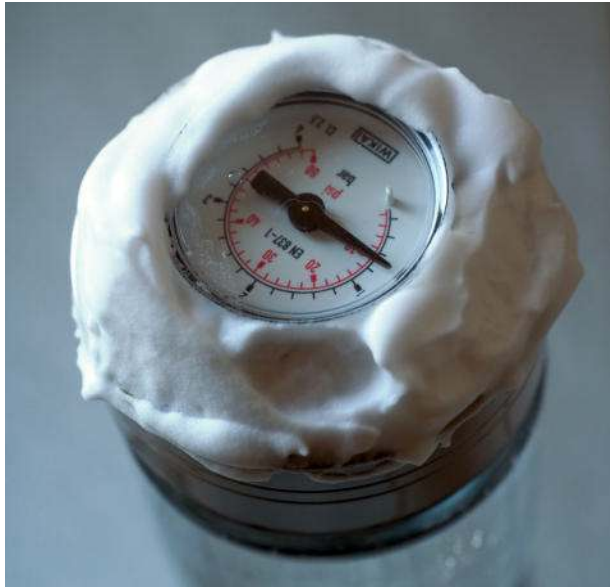
Dichtheitsprüfung mit Rasierschaum um Manometer und Anschluss Deckel-Glasflasche
