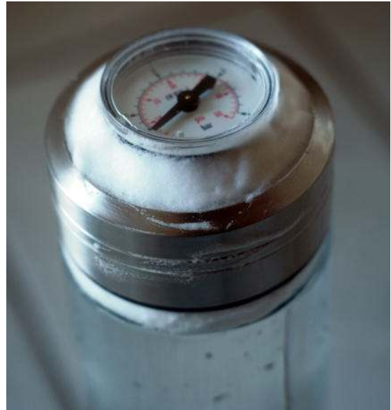
Dichtheitsprüfung mit Rasierschaum um Manometer und Anschluss Deckel-Glasflasche
