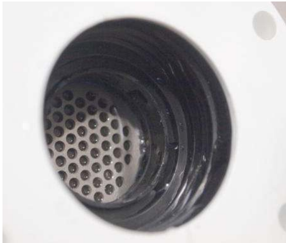
Erster Versuch: O-Ring in Winkel PEM/Gehäuse klemmen
